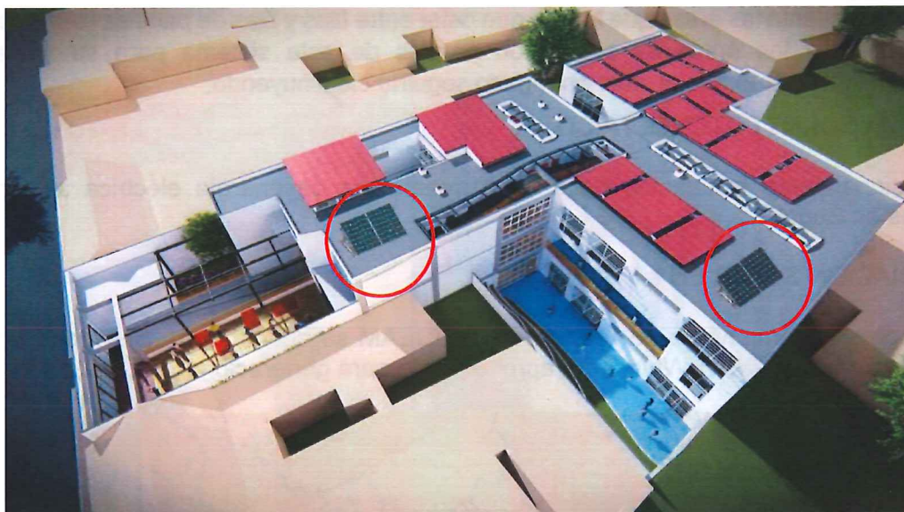
Ilustración 38 – Figura Cubierta – vista lateral donde se evidencia dos islas de 2 paneles solares
