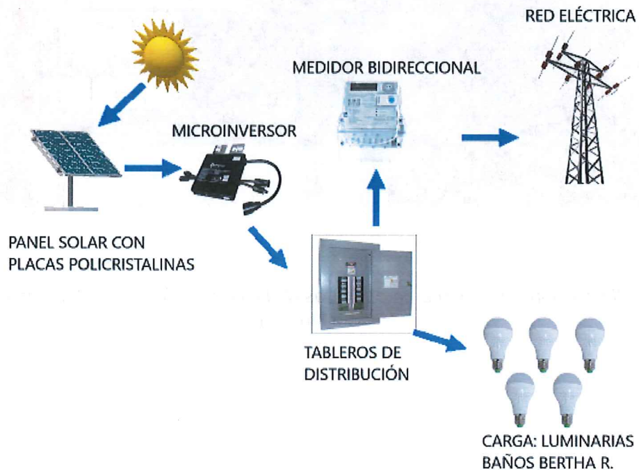
Ilustración 39 – Esquema de conexión sistema OnGrid Jardín Bertha R. Russi
