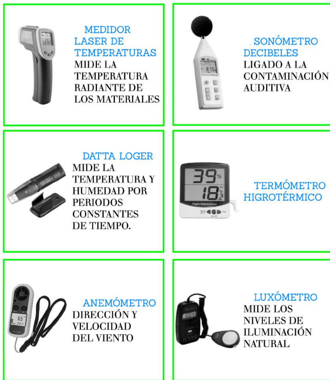
Imagen 15. Aparatos de medición . Fuente. Elaboración propia Efecto Habitar.
