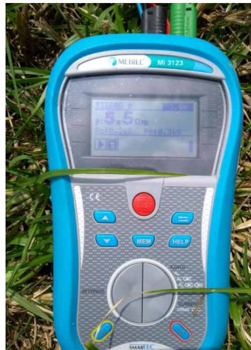
Imagen 4: Medición de resistividad del terreno
