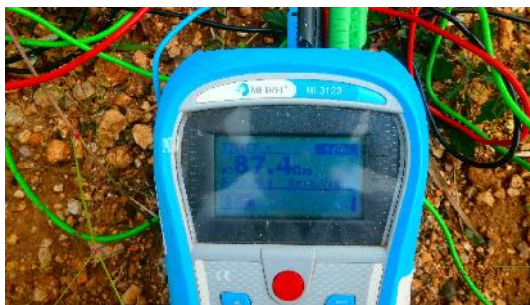
FOTO N.2 MEDIDA DE RESISTIVIDAD DEL TERRENO DEL PERFIL DE TERRENO 2
