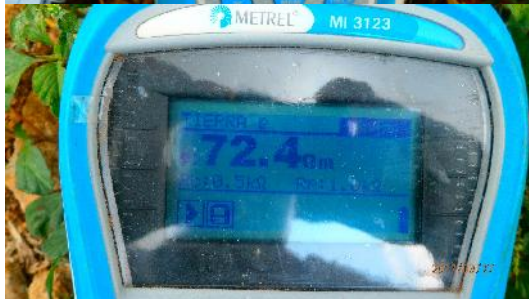
FOTO N.1 MEDIDA DE RESISTIVIDAD DEL TERRENO DEL PERFIL DE TERRENO 1
