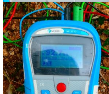
FOTO N.2 MEDIDA DE RESISTIVIDAD DEL TERRENO DEL PERFIL DE TERRENO 2
